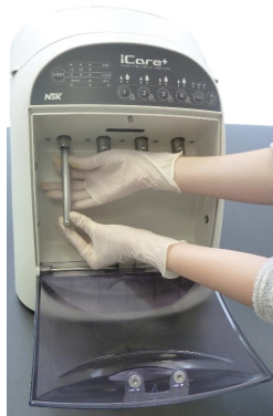
Fig.15 – Visser la bague de maintien
